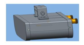
把安装架固定在天线中部安装片处,再将2pcs外六角螺丝M8X22装上,弹平垫装在螺母端,用18Nm扭矩拧紧螺母。
