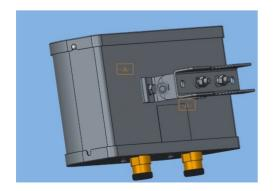
把1个夹码装到上步完成的安装架上,再装上2个外六角螺 丝M8X22,弹平垫装在螺母端。用18Nm扭矩拧紧螺母。
